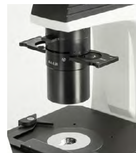
N.A. 0,3 condensatore di Abbe con cursore per contrasto di fase
